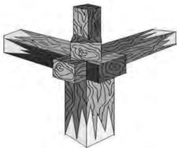
Fig. 42 – Structură de rezistență mixtă, cu stâlpi și bârne îmbinate cu „chiotori” – Seghiște, nr. 11
