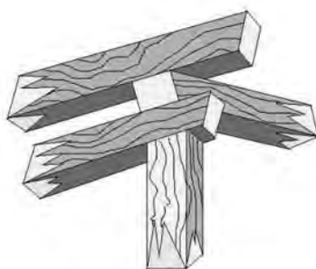
Fig. 43 – Sisteme de îmbinare a stâlpilor marginali cu grinzile centurii și cu stâlpișorii de supraînălțare
